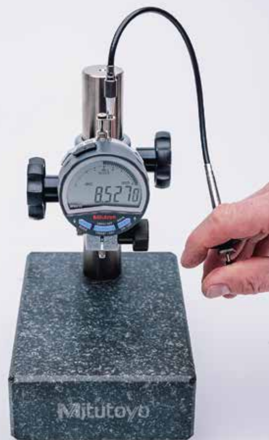
543-700B koos lisavarustusega: statiiv 215-150-10 ja tõstekaabel 21JZA295
