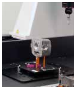
K551218: alumise vastuvõtja alusesüsteemi rakendus
